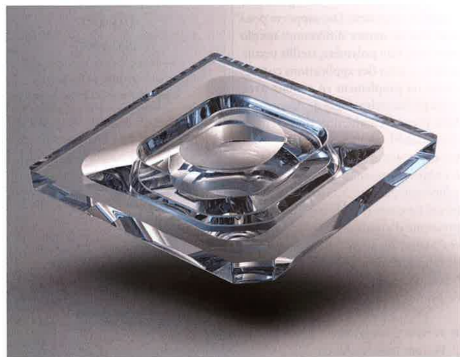
Illustration : Pièce complexe réalisée en micro-injection. Elle présente des zones optiques sur l'ensemble de ses surfaces, mesure 3,3 mm x 3,3 mm et pèse 3,8 mg
