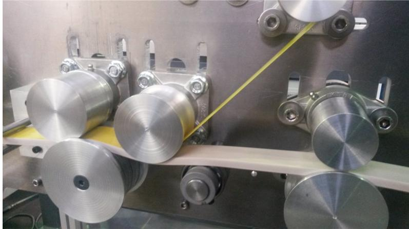
**A**insi pour répondre aux différents besoins, Sterne propose la pose d'adhésif sur différents supports silicone tels que : la feuille, les plaques moulées, et les profilés avec des largeurs pouvant aller de 6 mm à 60 mm maxi, et une hauteur de 20 mm maxi, sur différentes longueurs de couronnes. Sterne offre également une gamme standard d'adhésifs ayant pour avantages la résistance au cisaillement, aux agents chimiques, à l'humidité pour une large plage de température de fragilité.
