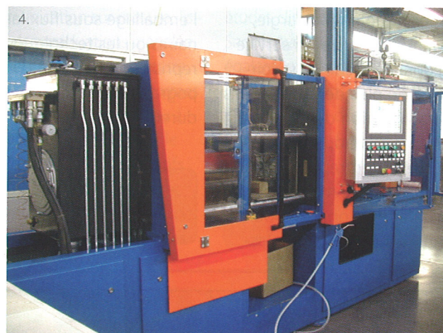
↑ 4. Photo de la presse d'injection du Staminalene destinée à la fabrication du dispositif bucco-dentaire de Sodis apf
